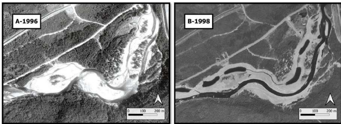
Figure 11 : Comparaison d'images aériennes du même secteur, prises en 1996 (A) et 1998 (B), montrant les modifications apportées dans la rivière à Mars après le passage de la crue de 1996. L'image A montre la rivière peu de temps après la crue avant les travaux de stabilisation. L'image B montre la rivière après les travaux.
